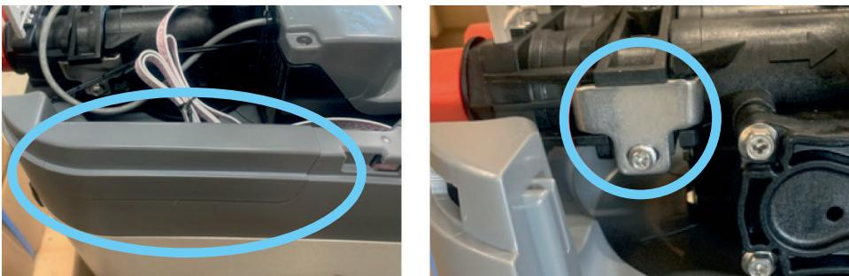
4. Verwijder de 2 grijze bevestigingen aan de achterkant van de ontharder. De in - en uitlaataansluitingen kunnen nu worden verwijderd door aan de in - en uitlaataansluitingen te trekken.
