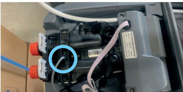
3. Verwijder de twee grijze zijpanelen en schroef de twee schroeven en de beugels los.
