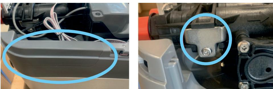
4. Retirez les 2 fixations grises à l'arrière de l'adoucisseur d'eau. L'assemblage des connecteurs d'entrée et de sortie est maintenant prêt à être retiré ; pour ce faire, tirez sur les connexions d'entrée et de sortie.
