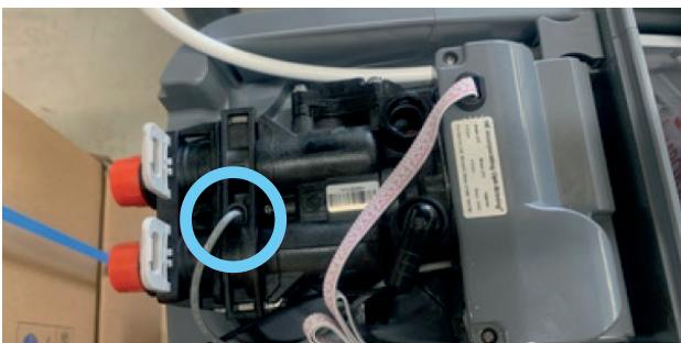
3. Retirez les deux panneaux latéraux gris et dévissez les deux vis et les supports.
